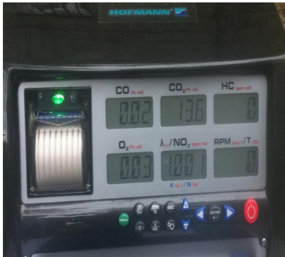
ნახ. 3.13. აირანალიზატორ Multitest 211 მიერ დაფიქსირებული მონაცემები ძრავის დატვირთვის რეჟიმზე მუშაობისას ( n=3000 წთ -1 ) ბენზინი და ბენზინი + წყალბადი
