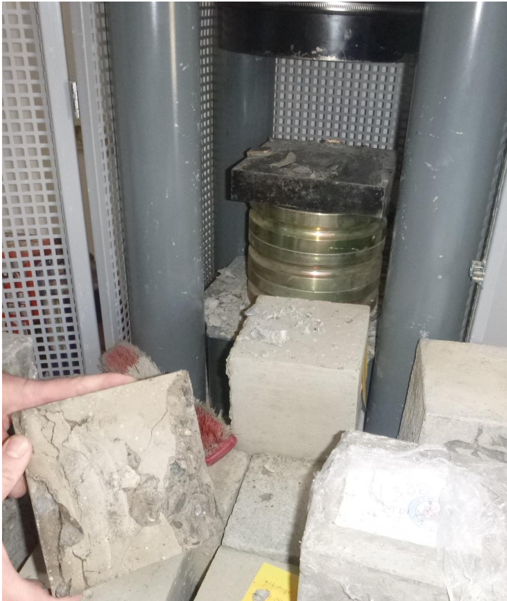
ფოტო 3.2. 3კ სერიის ნიმუში დაშლილი 0,63 დონეზე ძაბვით დატვირთვისას კერძოდ გაზრდილი იქნა ნიმუშების დატვირთვის დონე 0,24-დან 0,63-მდე.
