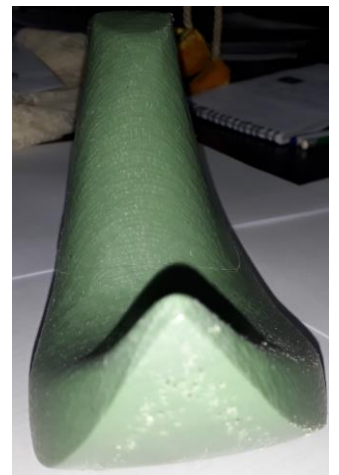
სურ. 67. კალაპოტის ცხვირის ნაწილის ფორმის 3D პროექტირების პროცესის ამსახველი ფრაგმენტები და კალაპოტის დასრულებული მაკეტი.
