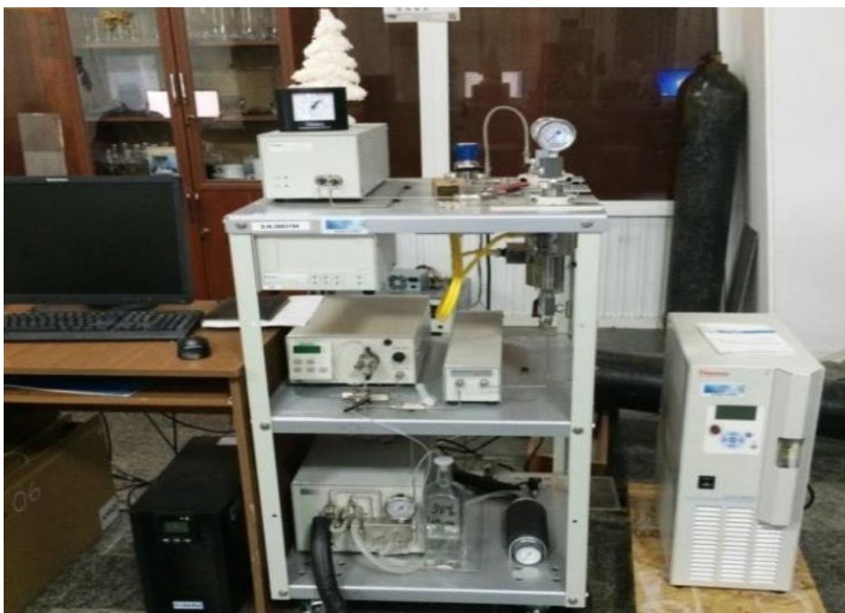
სურათი 2.3. Water Corporation-ის ზეკრიტიკული სუპერ ფლუიდური ექსტრაქტორი SFE - 100-2-C10
