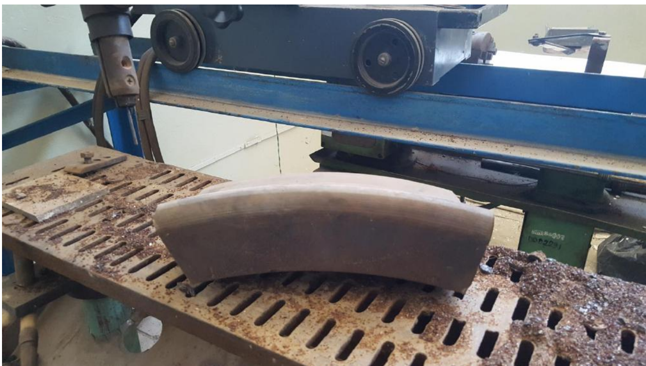
სურ. 4.2 გოგორათვალისანი ამოჭრილი ნიმუშის ფრაგმენტი შემდგომი მექანიკური დამუშავებისა და შედუღებისათვის
