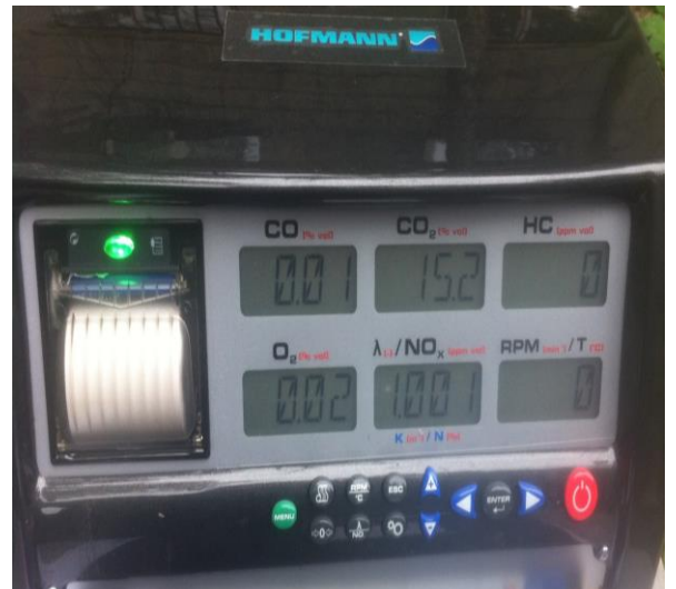
ნახ. 3.13. აირანალიზატორ Multitest 211 მიერ დაფიქსირებული მონაცემები ძრავის დატვირთვის რეჟიმზე მუშაობისას ( n=3000 \text{ წთ}^{-1} ) ბენზინი და ბენზინი + წყალბადი
