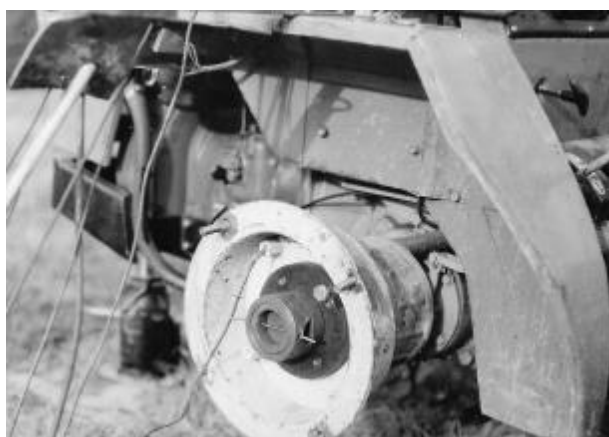
ნახ.5.10 და ნახ.5.11. ნახევარღერძების აღჭურვა გადამწოდებითა და დენისამრთმევეებით
