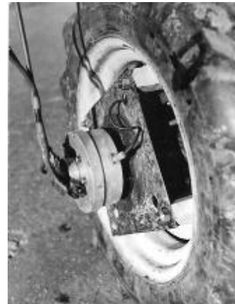
ნახ.5.10 და ნახ.5.11. ნახევარღერძების აღჭურვა გადამწოდებითა და დენისამრთმევეებით
