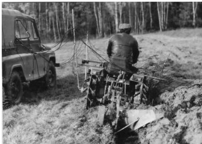
ნახ.5.13. ტენზომეტრული სიგნალების რეგისტრაცია თანმხლებ ავტომობილში
