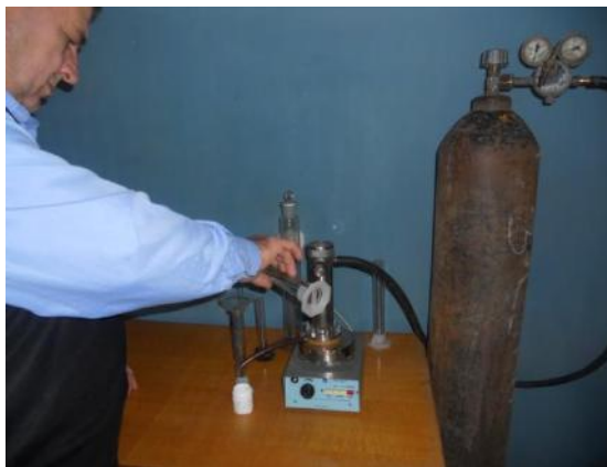
ნახ.4.21. ჩიხში ულტრაფილტრაციის ამრევიანი მემბრანული უჯრედი
