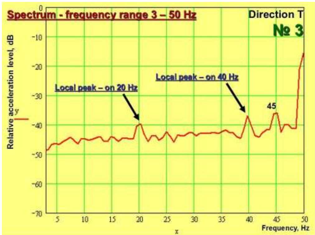
ნახ. 4.25. რადიალური მიმართულებით გაზომილი ვიბრაციის სპექტრის სიხშირული დიაპაზონი 5-50 ჰც
