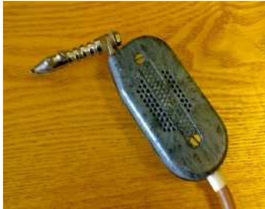
ნახ. 4.3 ელექტრონაპერწკლური ლეგირების ხელსაწყოს ელექტროდის დამჭერი
