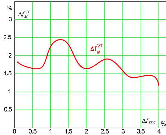
ნახ. 51. მართვის სიგნალების სიხშირის საშუალო გადახრის, ცდომილება თეორიული და ვირტუალური კვლევის შედეგების მიხედვით.
