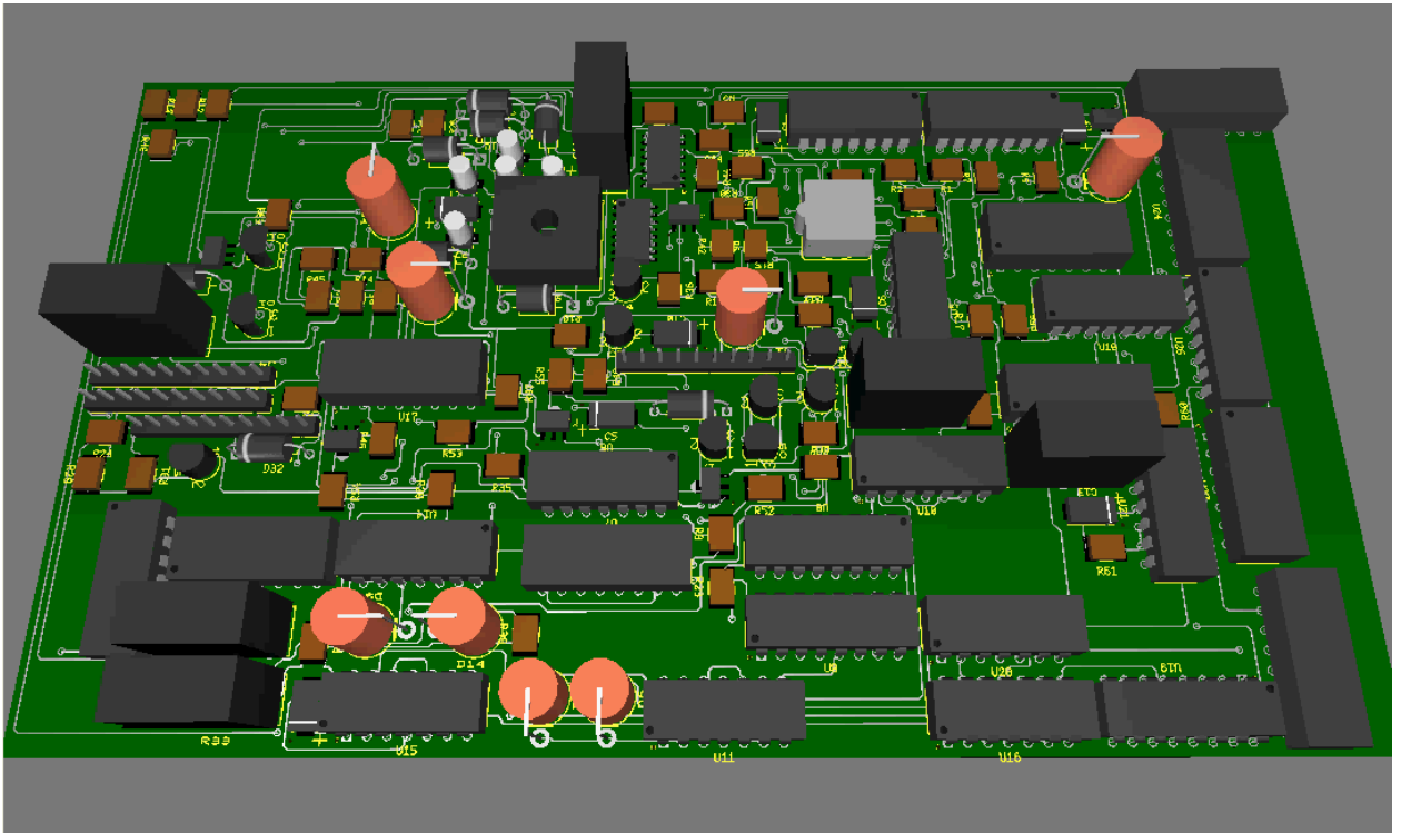
ნახ. 80. უნიფიცირებული ძაბვის რეგულიატორის ექსპერიმენტალური მოქმედი მოდელის ვირტუალური ვარიანტი
