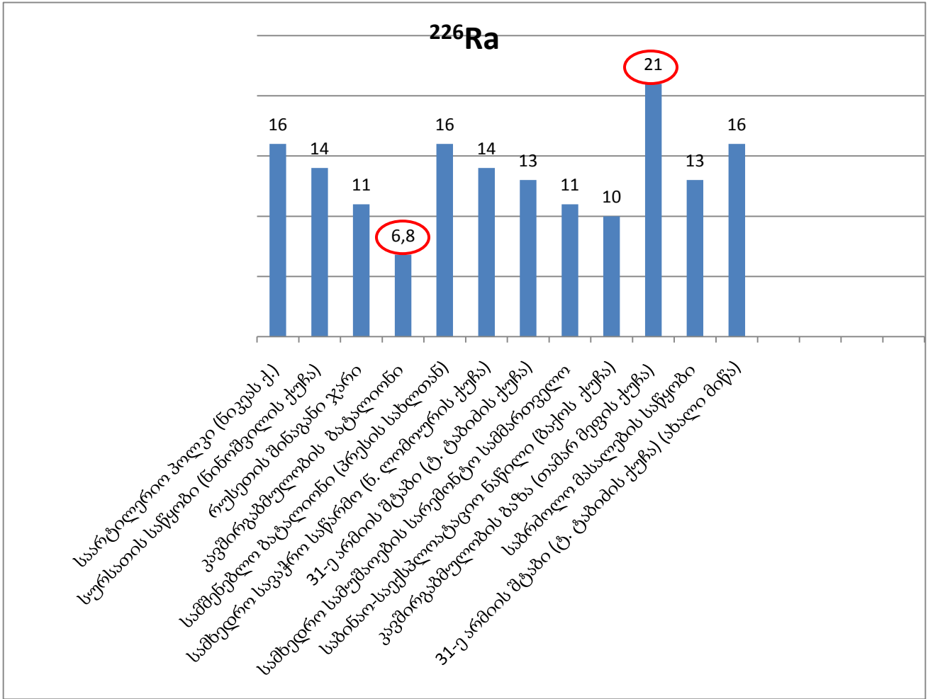
დიაგრამა 5.3. ^{226}\text{Ra} -ის შემცველობა ყოფილი საბჭოთა შეიარაღებული ძალების სამხედრო ნაწილების ქალაქ ქუთაისში დისლოკაციის ადგილების ნიადაგებში
