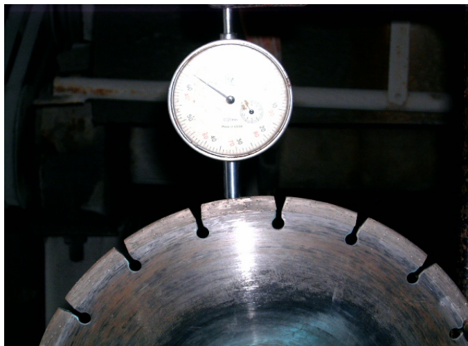
ნახ.3.4. სეგმენტური ალმასური იარაღის ცვეთის გასაზომი ხელსაწყო
