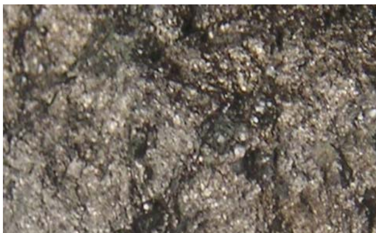
ნახ.2.19. ტრადიციული მეთოდით მიღებული სხმულის ტრანსკრისტალიზაციის და გულის მიმდებარე ზონის მაკროსტრუქტურა
