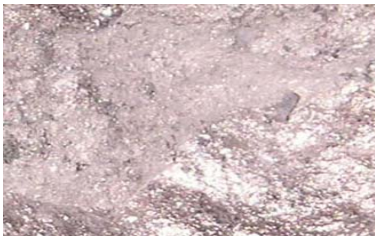
ნახ.2.18. სუსპენზიური მეთოდით მიღებული სხმულის ტრანსკრისტალიზაციის და გულის მიმდებარე ზონის მაკროსტრუქტურა
