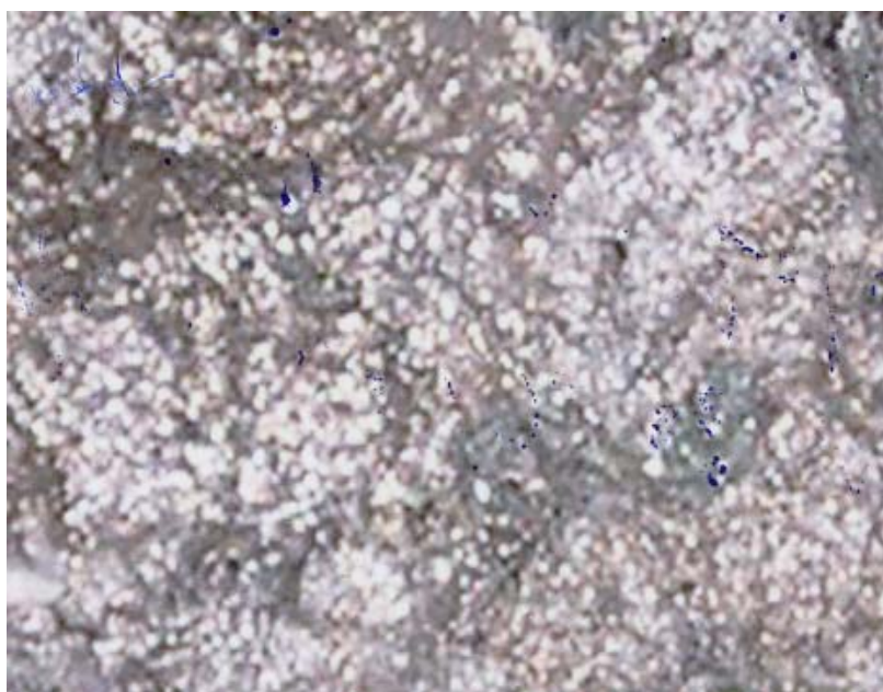
ნახ.2.16. სუსპენზიური მეთოდით მიღებული სხმულის მაკროაგებულება.
