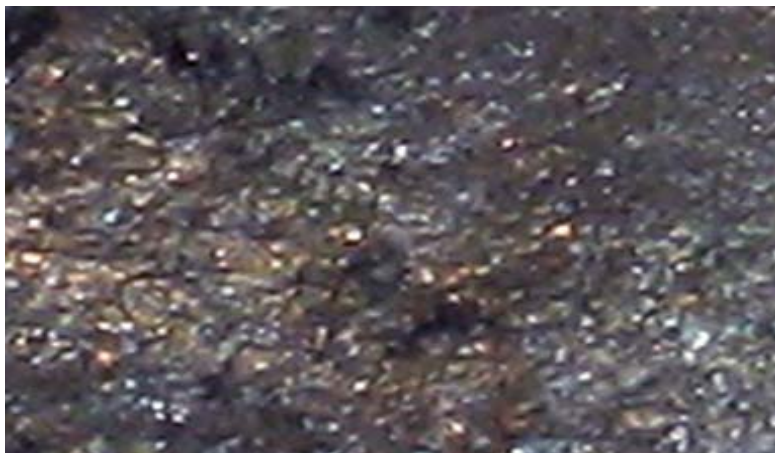
ნახ.4.7. არაკონდიციური მისართის (0-3მმ) გამოყენებით სუსპენზიური მეთოდით მიღებული ფეროსილიკომანგანუმის სხმულის მაკროსტრუქტურა
