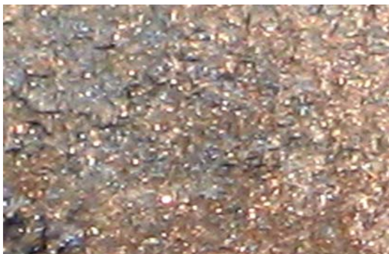
ნახ.4.8. არაკონდიციური მისართის (3-5მმ) გამოყენებით სუსპენზიური მეთოდით მიღებული ფეროსილიკომანგანუმის სხმულის მაკროსტრუქტურა
