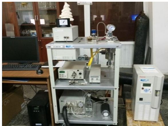
სურ.5 Water Corporation-ის ზეკრიტიკული სუპერ ფლუიდური ექსტრაქტორი SFE- 100-2-C10,
