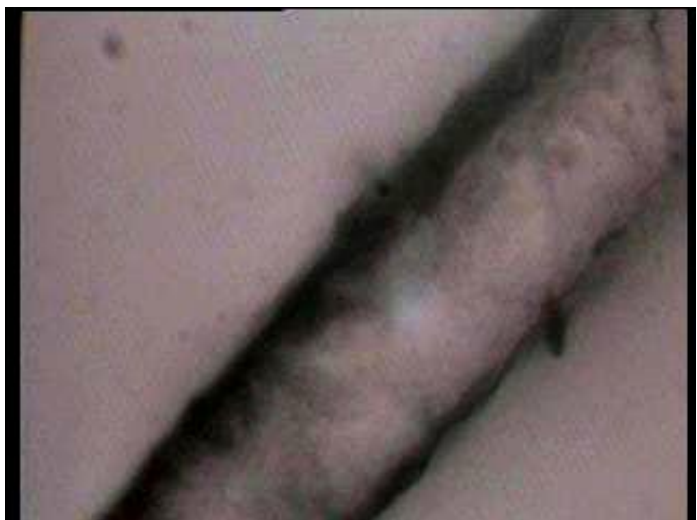
ნახაზი 3.11. ადგილობრივი ცხვრის დაუმუშავებელი (ა), მოდიფიკატორში A (ბ) და მოდიფიკატორში B (გ) დამუშავებული მატყლის ზედაპირული სტრუქტურა 2000-ჯერადი გადიდებისას.
