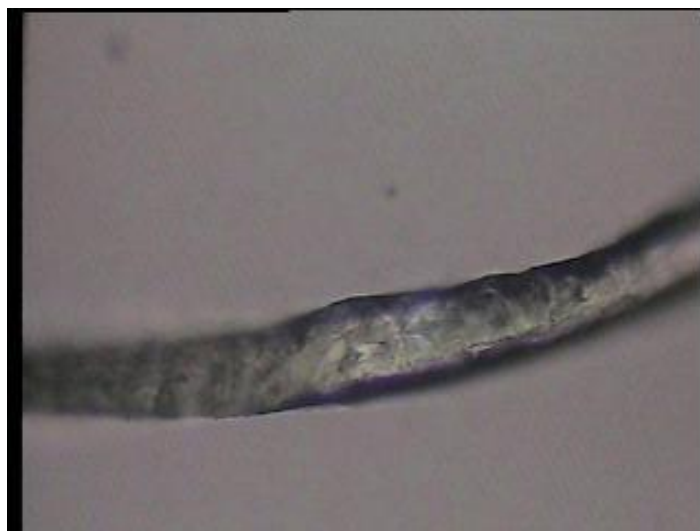
ნახაზი 3.12. მერინოსის ჯიშის ცხვრის დაუმუშავებელი (ა), მოდიფიკატორში A (ბ) და მოდიფიკატორში B (გ) დამუშავებული მატყლის ზედაპირული სტრუქტურა 800-ჯერადი გადიდებისას.
