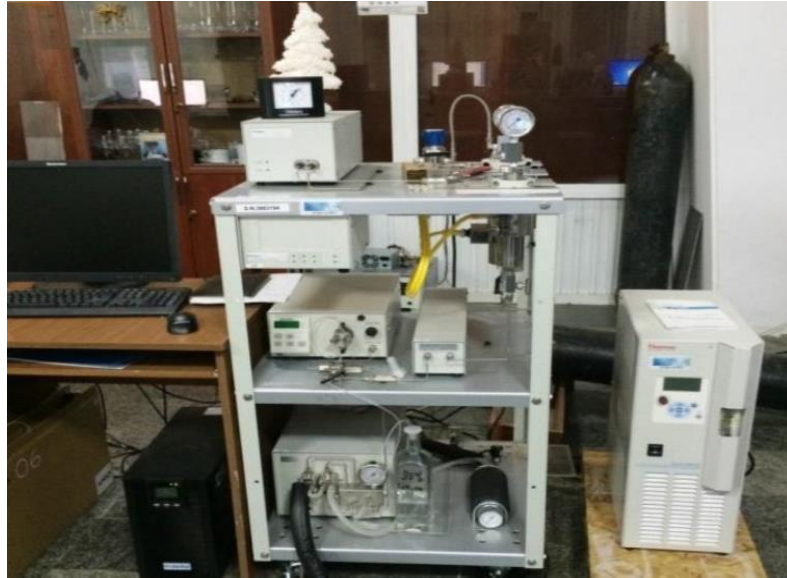
სურათი 20. Water Corporation-ის ზეკრიტიკული სუპერ ფლუიდური ექსტრაქტორი SFE - 100-2-C10
