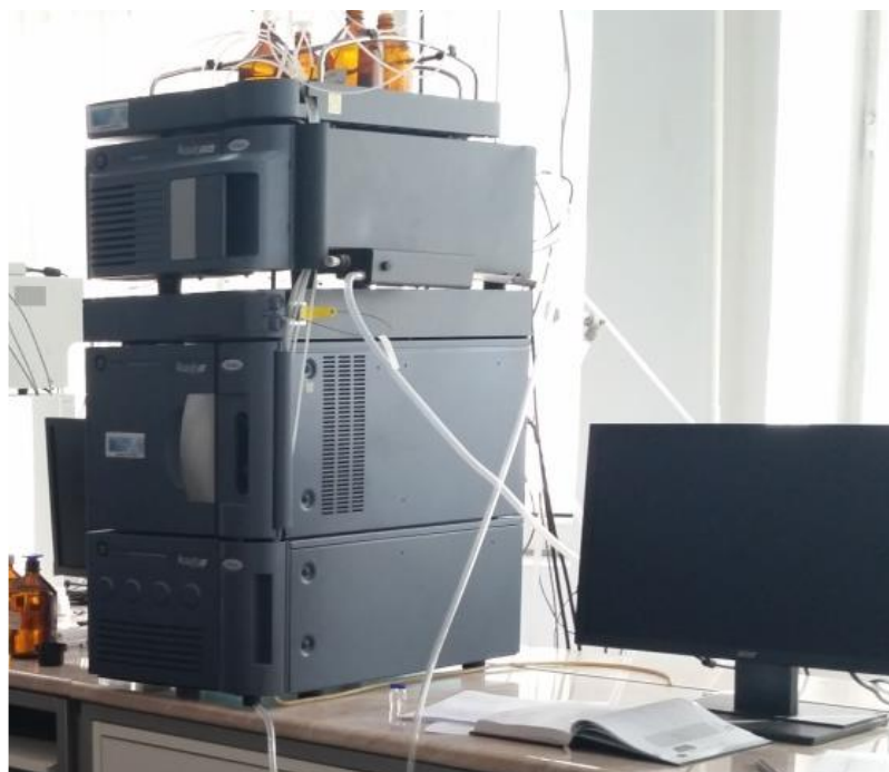
სურათი 17. ულტრა - მაღალი წნევის სითხოვანი ქრომატოგრაფი მას-დეტექტორით
