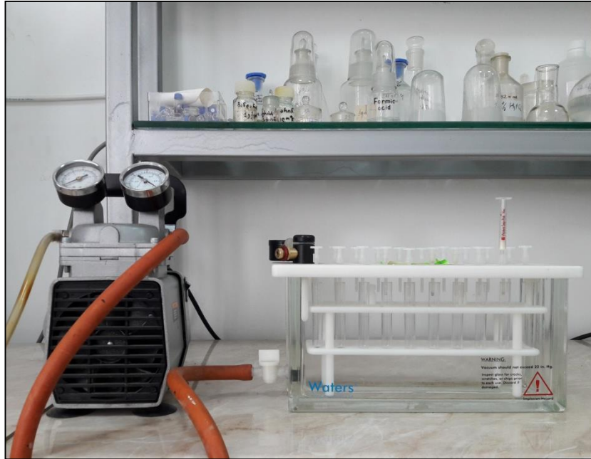
სურათი 16. ლაბორატორიული მყარ ფაზოვანი საექსტრაქციო აპარატი
