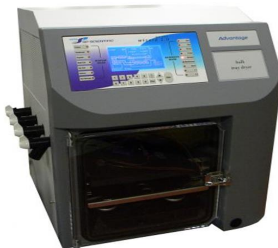
სურათი 21. ლაბორატორიული ლიოფილური საშრობი
