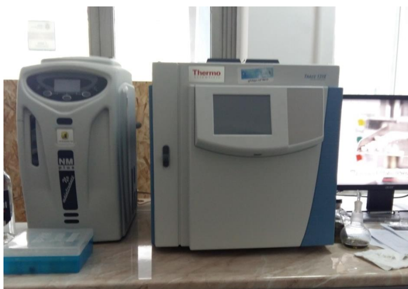
სურათი 18. გაზური ქრომატოგრაფი (TRACE™ 1310 Gas Chromatograph - Thermo Scientific)
