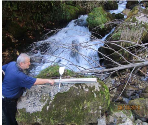
სურ. 4. მდ. რანხაზე სოფ. მახურას მცირე ჰიდროელექტრო სადგურის მონაკვეთზე წყლის ნაკადის სიღრმის განსაზღვრის მომენტში.
