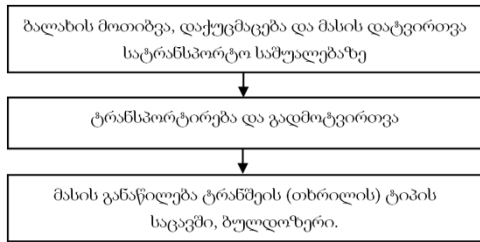
ნახ. 1. სასილოსე კულტურებისა და ბალახეულის სასილოსედ ამღები მანქანათა ტექნოლოგიური კომპლექსი და ტექნოლოგია.
