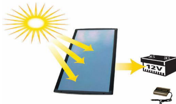
სურ.3 მზის ფოტოელექტროსისტემა (ფოტოელემენტი, აკუმულატორული ბატარეა და ინვერტორი)
