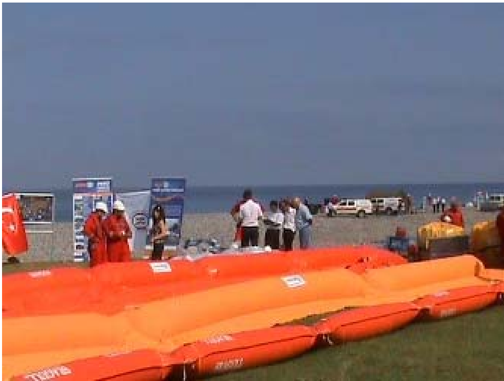
Рис.4. Специальное техническое средство боновые ограждение для локализации нефтяного пятна.
