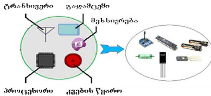
ნახ.2 სენსორული ქსელის კვანძის მოდელი და მისი აპარატურული შემადგენლობა
