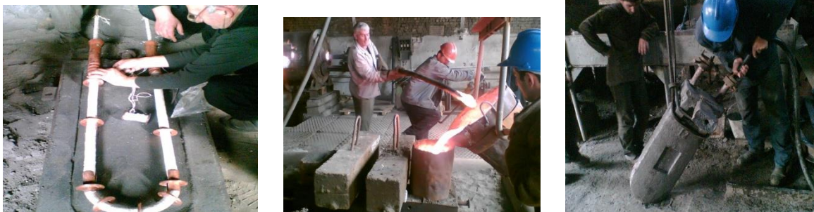
Рис.2. Технология изготовления „щёчек” из композиционных материалов.
