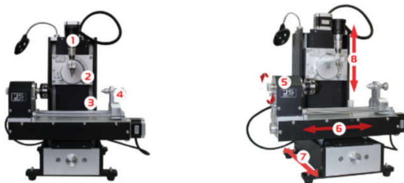
Рис. 2. Фрезерный станок WM-1400: a – внешний вид составляющих: 1 – шпиндель, 2 – градусная сетка, 3 – датчик нуля, 4 – задняя бабка; b – оси перемещения рабочих зон: 5 – ось А – с рабочим ходом 360°, 6 – ось X с рабочим ходом 180 мм, 7 – ось Y с рабочим ходом 110 мм, 8 – ось Z с рабочим ходом 160 мм
